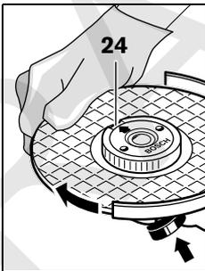
Za zaustavljanje vretena pritisnite tipku za uglavljivanje vretena **2**. Za stezanje brzostežuće matice okrenite brusnu ploču snažno u smjeru kazaljke na satu.
