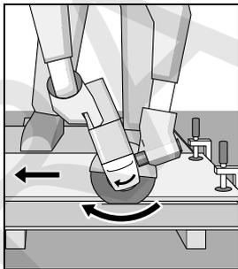
Električni alat mora se uvijek voditi protuhodno. Međutim postoji opasnost da se **nekontrolirano** istisne iz reza.
