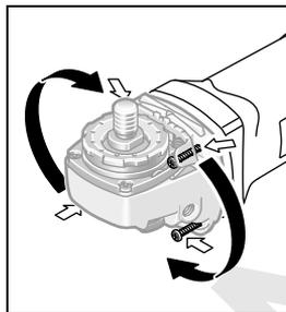
Prevodovú hlavu môžete otáčať po krokoch v hodnote  $90^\circ$  stupňov. Takýmto spôsobom si môžete v špeciálnych prípadoch nastaviť vypínač do výhodnejšej polohy, napríklad pri rezaní s odsávacím krytom pomocou vodiacich saní 21, alebo ak ste ľavákom.
