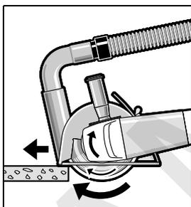
Vklopite električno orodje in ga s sprednjim delom drsnega vodila postavite na obdelovanelec. Električno orodje pomikajte z zmernim pomikom, ki ga morate prilagoditi materialu, ki ga obdelujete.
