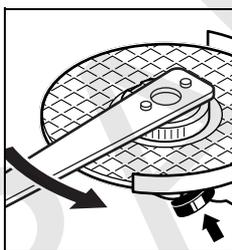
Правильно закрепленную, не имеющую повреждений быстрозажимную гайку Вы можете отвернуть, вращая рукой кольцо с накаткой против часовой стрелки.
