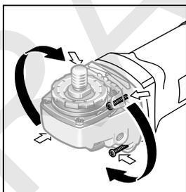
Hlavu převodovky můžete otočit v krocích po  $90^\circ$ . Tím lze uvést spínač pro zvláštní případy práce do výhodnější manipulační polohy, např. pro dělicí práce s odsávacím krytem s dělicími saněmi **21** nebo pro leváky.
