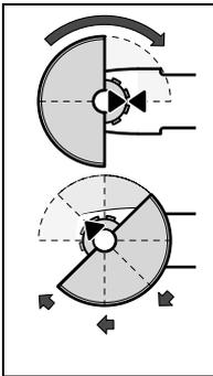
Надіньте захисний кожух **12** на шийку шпинделя, як це показано на малюнку. Трикутні позначки на захисному кожусі повинні збігатися з відповідними позначками на головці редуктора.
