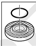
V upínacej prírubke **8** je okolo centrovacieho nástavca vložený element z plastu (okružla podložka). **Ak táto okružla podložka chýba, alebo ak je poškodená, upínaciu prírubu **8** treba pred ďalším používaním bezpodmienečne vymeniť za novú.**
