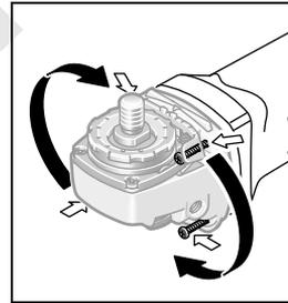
Головку редуктора можна повертати з інтервалом у 90°. Завдяки цьому вимикач буде знаходитися у більш зручному для певних видів роботи положенні, напр., при розрізанні з витяжним ковпаком з люнетним супортом 21 або якщо Ви ліва.
