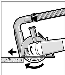
Elektronářadí zapněte a posadte jej předním dílem vodících saní na obrobek. Elektronářadí posouvajte s mírným, opracovávanému materiálu přizpůsobeným posuvem.
