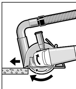
Ieslēdziet elektroinstrumentu un novietojiet vadotnes priekšējo daļu uz griezamā priekšmeta. Vienmērīgi virziet elektroinstrumentu pa griezamo priekšmetu ar mērenu ātrumu, kas atbilst griezamā materiāla īpašībām.
