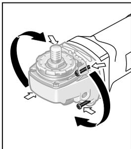
Погонската глава може да ја вртите на 90°-нивоа. Притоа, прекинувачот за исклучување/вклучување може да се постави во поповолна позиција при изведување на посебни случаи на работа, на пр. сечење со хауба за вшмукување со лизгачка водилка **21** или за левораки лица.
