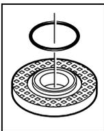
În flansa de prindere **8**, în jurul gulerului de centrare este montată o piesă din plastic (garnitură inelară). **În cazul în care garnitura inelară lipsește sau este deteriorată**, flansa de prindere **8** trebuie neapărat înlocuită înainte de reutilizare.
