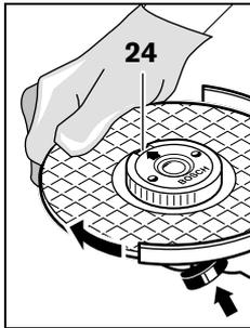
Ustalić położenie wrzeciona za pomocą przycisku blokady **2**. Nakrętkę szybko mocującą dociągnąć, mocno przekraczając tarczę szlifierską w kierunku zgodnym z ruchem wskazówek zegara.
