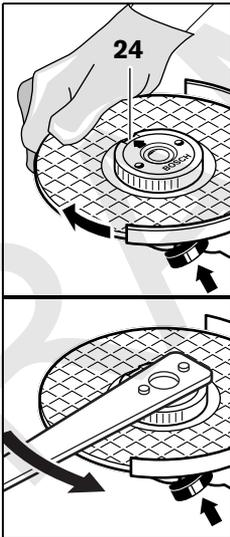
Натисніть на фіксатор шпінделя 2, щоб зупинити шліфувальний шпindel. Для затягнення швидкозатискної гайки з силою поверніть шліфувальний круг за стрілкою годинника.
