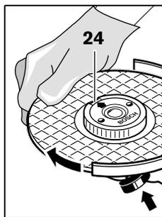
Pritisnite tipko za aretiranje vretena **2** in fiksirajte brusilno vreteno. Trdno privijte hitrovpenjalno matico z obračanjem brusilnega koluta v urini smeri.
