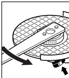
Puteți slăbi o piuliță de strângere rapidă fixată corespunzător, nedeteriorată, rotind cu mâna, în sens contrar mișcării acelor de ceasornic, inelul zimțat.
