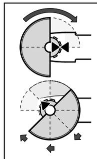
Поставете предпазния кожух **12** на шийката на електроинструмента, както е показано на фигурата. Триъгълните маркировки на предпазния кожух трябва да съвпадат със съответните маркировки на главата на редуктора.
