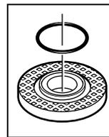
На опорном фланце **8** вокруг центрального буртика находится пластмассовая деталь (кольцо круглого сечения). Если кольцо круглого сечения отсутствует или повреждено, опорный фланец **8** необходимо обязательно заменить перед дальнейшим применением.
