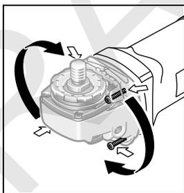
Možete glavu prenosioca okretati u  $90^\circ$  podeoka. Na taj način se prekidač za uključivanje-isključivanje za posebne radne slučajeve dovodi u povoljniju poziciju za rukovanje, na primer za radove presecanja sa usisavajućom haubom sa klizajućom vodjicom **21** ili za levoruke.
