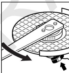
Egy előírászerűen rögzített hibátlan gyorsbefogó anyát a recézett gyűrűnek az óramutató járásával ellentétes irányba való elforgatásával kézzel ki lehet lazítani.
