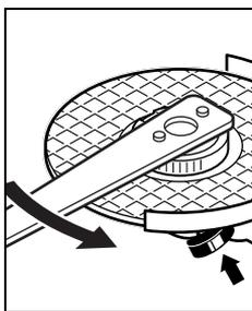
Řádně upevněnou, nepoškozenou rychloupínací matici můžete uvolnit rukou otáčením ryhovaného kroužku proti směru hodinových ručiček. **Pevně usazenou rychloupínací matici nikdy neuvolňujte pomocí kleští, nýbrž použijte klíč se dvěma čepy.** Klíč se dvěma čepy nasadte jak je zobrazeno na obrázku.
