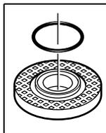
V upínací přírubě 8 je kolem středícího osazení vložen díl z umělé hmoty (o-kroužek). Pokud o-kroužek chybí nebo je poškozen, musí být před dalším používáním upínací příruba 8 bezpodmínečně vyměněna.
