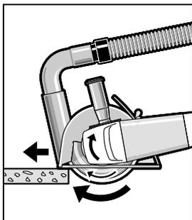
Вклучете го електричниот апарат и поставете го со предниот дел на лизгачките водилки на делот што се обработува. Поместувајте го електричниот апарат со умерено движење по материјалот што се обработува.
