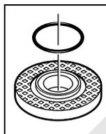
Balstaplāksnes **8** centrējošo izcilni aptver plastmasas detaļa (O veida gredzens). **Ja O veida gredzena trūkst vai arī tas ir bojāts, balstaplāksne 8 pirms instrumenta tālākas lietošanas noteikti jānomaina.**
