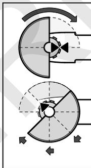
Novietojiet slīpēšanas aizsargu **12** uz darbvārpstas aptveres, kā parādīts attēlā. Trijstūra veida marķējumiem uz aizsarga jāsakrīt ar atbilstošiem marķējumiem uz elektroinstrumenta pārnese galvas.
