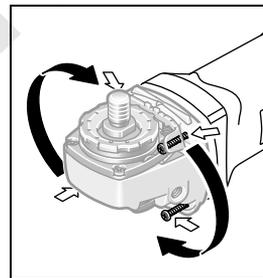
Можете да завъртите главата на редуктора на стъпки от по  $90^\circ$ . Така при специални работни условия пусковият прекъсвач може да бъде поставен в по-удобна позиция, напр. при рязане с използване на предпазния кожух с прахоулавяне и водеща шейна 21 или ако работите с лявата ръка.
