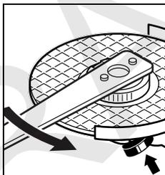
Затегната правилно, неповредена гайка за бързо застопоряване може да бъде развита чрез завъртане на ръка на накатения пръстен в посока, обратна на часовниковата стрелка.
