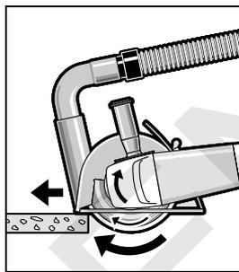
Uključite električni alat i stavite ga na izradak sa prednjim dijelom vodilica. Pomičite električni alat sa umjerenim posmakom prilagođenim obrađivanom materijalu.
