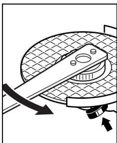
Jednu propisno učvršćenu, neoštećenu navrtku sa brzim zatezanjem možete rukom odvrnuti okretanjem nareckanog prstena nasuprot smeru kazaljke na satu.
