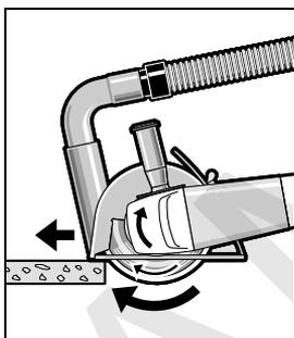
Uključite električni alat i stavite ga sa prednjim delom klizača vodjice na radni komad. Gurajte električni alat sa umerenim pomeranjem napred koje je prilagodjeno materijalu koji se obrađuje.
