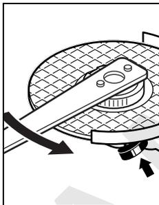
Prawidłowo zamocowana, nieuszkodzona nakrętka mocująca pozwala się łatwo poluzować ręką, poprzez obracanie pierścieniem radełkowym w kierunku przeciwnym do ruchu wskazówek zegara. **Mocno dokręconej nakrętki nie zwalniać nigdy za pomocą szczypic lub kombinerek. Stosować wyłącznie klucz dwutrzeniowy.** Klucz nasadzać, jak pokazano na rysunku.
