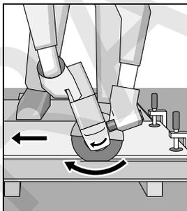
Az elektromos kéziszerszámot mindig a forgással ellenkező irányba kell vezetni. Ellenkező esetben a készülék **irányíthatatlanul** kiugorhat a vágásból.
