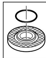
В опорному фланці **8** на центруючому пояску знаходиться пластмасова деталь (кілець круглого перерізу). Якщо кілець круглого перерізу відсутнє або пошкоджене, опорний фланець **8** необхідно обов'язково замінити перед подальшим використанням.
