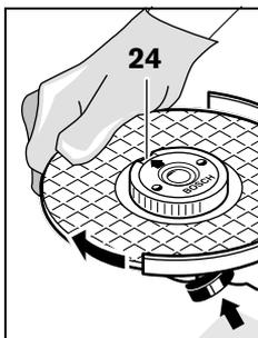
Для фиксации шлифовального шпинделя нажмите кнопку фиксации шпинделя 2. Для затягивания быстрозажимной гайки поверните шлифовальный круг с усилием по часовой стрелке.
