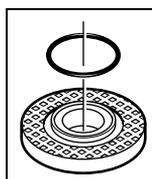
На центровращото стъпало на фланеца **8** е поставен уплътнителен елемент (O-пръстен). **Ако O-пръстенът липсва или е повреден**, преди използване на електроинструмента центровращият фланец **8** трябва задължително да бъде заменен.
