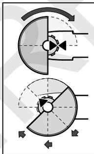
Қорғағыш қаптаманы **12** шпиндель мойнына суретке сай кіргізіңіз. Қорғағыш қаптаманың үшбұрышты белгілері редуктор басындағы сәйкес белгілерге сәйкес келуі керек.
