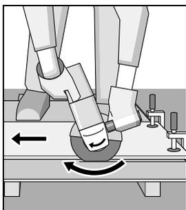
Električni alat mora uvek da se vodi u suprotnom smeru kretanja. Inače postoji opasnost, da se **nekontrolisano** istisne iz reza.
