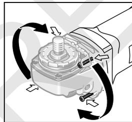
Głowica przekładni obracana jest w czterech skokach (co  $90^\circ$ ). Pozwala to na ustawienie włącznika/wyłącznika w wygodniejszej pozycji roboczej w przypadku specyficznych zastosowań, np. podczas cięcia przy użyciu pokrywy odsysającej z przewodniczą saneczkową **21**, a także dla osób leworęcznych.
