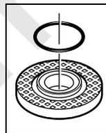
W kołnierzu **8**, w podtoczeniu znajduje się okrągły pierścień uszczelniający (tzw. o-ring). **Jeżeli brakuje tej uszczelki, lub jest ona uszkodzona, kołnierz mocujący 8 należy koniecznie wymienić przed przystąpieniem do dalszej eksploatacji narzędzia.**
