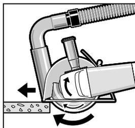
Porneți scula electrică și puneți-o cu partea anterioară a saniei de ghidare pe piesa de lucru. Împingeți scula electrică cu avans moderat, adaptat materialului de prelucrat.
