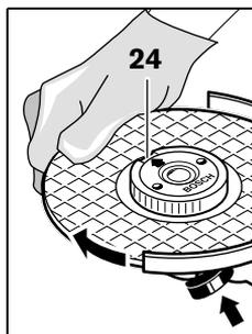
Pritisnite taster za blokadu vretena **2** da bi utvrdili brusno vreteno. Da bi stegli navrtku sa brzim zatezanjem, okrenite brusnu ploču snažno u pravcu kazaljke na satu.
