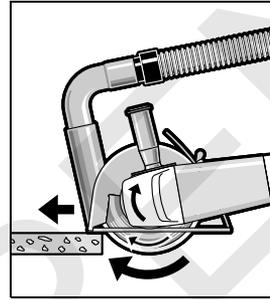
Увімкніть електроприлад і приставте його передньою частиною люнетного супорта до оброблюваного матеріалу. Помірно просувайте електроприлад у відповідності до оброблюваного матеріалу.
