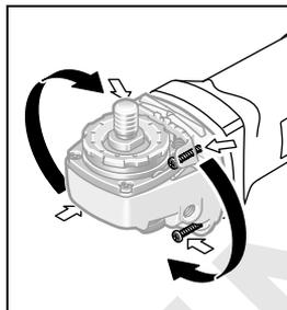
Elektroinstrumenta pārnesuma galva ir pagriežama ar soli  $90^\circ$ . Tas spēj atvieglot darbu īpašās situācijās, jo lietotājam ir iespēja izvēlēties izdevīgāko ieslēdzēja novietojumu, piemēram, darbinot elektroinstrumentu kopā ar griešanas aizsargpārsegu ar putekļu uzsūkšanu un griešanas vadotni **21**, kā arī gadiju-
