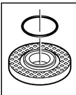
U steznoj prirubnici **8** oko naslona za centriranje ugrađen je plastični dio (O-prsten). **Ako O-prsten nedostaje ili je oštećen**, prije daljnje primjene, stezna prirubnica **8** se mora neizostavno zamijeniti.
