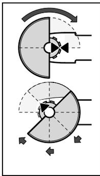
Montați apărătoarea de protecție **12** conform figurii, pe gulerul axului. Reperele triunghiulare de pe apărătoarea de protecție trebuie să coincidă cu reperele corespunzătoare de pe capul angrenajului.
