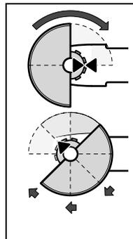
Насадите защитный кожух **12** на шейку шпинделя согласно рисунку. Треугольные метки защитного кожуха должны совпадать с соответствующими метками на головке редуктора.
