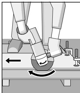
Електричниот апарат секогаш мора да се води во спротивен правец на движење. Инаку постои опасност, тој **неконтролирано** да се истисне од резот.
