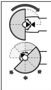
Helyezze fel a **12** védőbúrát az ábrán látható módon az orsónyakra. A védőburkolaton található háromszögletű jelzéseknek egybe kell esniük a hajtóműfejen található megfelelő jelölésekkel.
