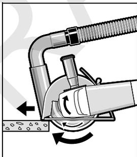
Zapnite ručné elektrické náradie a priložte ho prednou časťou vodiacich saní na obrobok. Miernym posuvom, ktorý zodpovedá obrábanému materiálu, prísúvajte náradie k obrobku.
