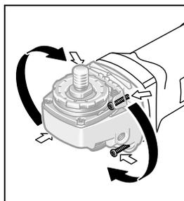
Glavu prijenosnika možete zakrenuti u koraci- ma do  $90^\circ$ . Na taj se način prekidač za uključivanje/isključivanje može prebaciti u povoljniji položaj rukovanja za posebne slučajeve primjene, npr. za radove rezanja sa usisnom haubom sa vodičicama **21** ili za ljevake. Do kraja odvijte 4 vijka.
