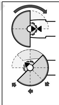
Ochranný kryt **12** umístěte podle vyobrazení na krk vřetene. Trojúhelníkové značky na ochranném krytu musí souhlasit s příslušnými značkami na hlavě převodovky.
