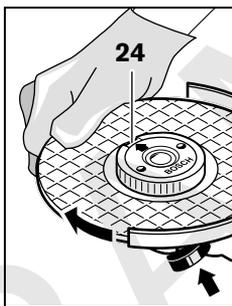
A csiszolótengely rögzítéséhez nyomja meg a 2 tengelyrögzítőgombot. A gyorsbefogó anyát megcsiszolásához fordítsa el a csiszolótárcsát erőteljesen az óramutató járásával megegyező irányban.
