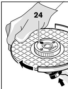
Натиснете бутона за блокиране на вала 2 за да го застопорите. За да затегнете гайката за бързо застопоряване, завъртете диска силно по посока на часовниковата стрелка.
