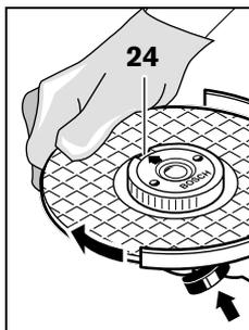
Stlačte aretační tlačítko vřetene 2, aby se brusné vřeteno zajistilo. Pro pevné utažení rychloupínací matice otočte brusný kotouč silou ve směru hodinových ručiček.
