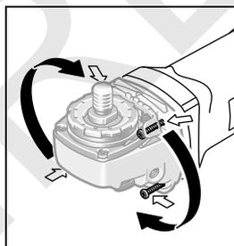
Редукторная головка может поворачиваться с интервалом в 90°. Таким образом выключатель может быть установлен в удобное для работы положение, например, для отрезных работ с вытяжным колпаком и направляющими салазками 21 или для левши.
